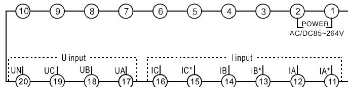
注:带\*号为电流输入进线, 进出线接反, 电能计量到反相电能。
